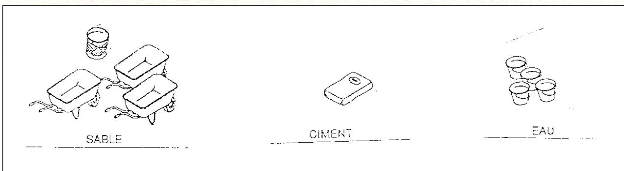
Le mortier pour la fabrication des parpaings ordinaires compactés à la main est dosé à 250 Kg/m<sup>3</sup>. Pratiquement on utilise 1 sac de ciment, 4 brouettes de sable et environ 40 litres d'eau pour produire :
